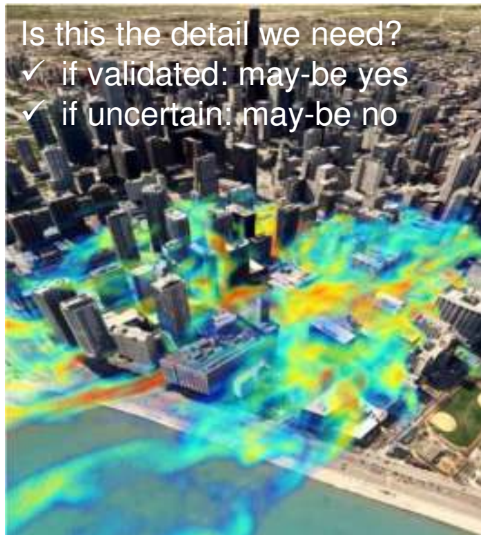
CFD - Large Eddy Simulation (LES), Lucas et al, 2016 (LLNL)
